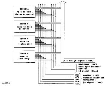
Figure 10-1. HP-IB Structure
